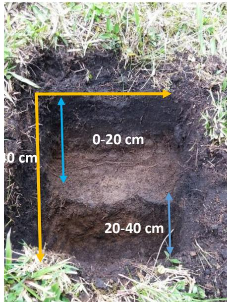
En el muestreo se hizo necesario eliminar la vegetación, y para las muestras sin disturbar se utilizó un anillo de acero de volumen conocido (5cm de diámetro, 2,5cm de alto y 2mm de grosor) que se colocó horizontalmente sobre la superficie del suelo, sobre este se coloca el muestreador que se golpeó uniformemente para poder introducir el anillo sin afectar la muestra (Figura 5).
