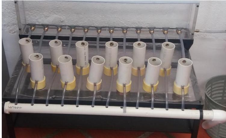
Figura 10. Determinación de conductividad hidráulica en laboratorio.
