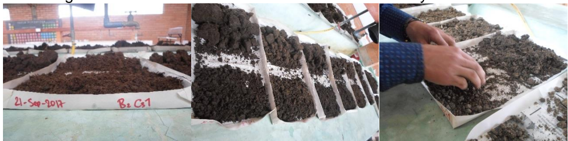
a. Bandejas de secado b. Muestras de suelo c. Retiro de piedras y raíces
