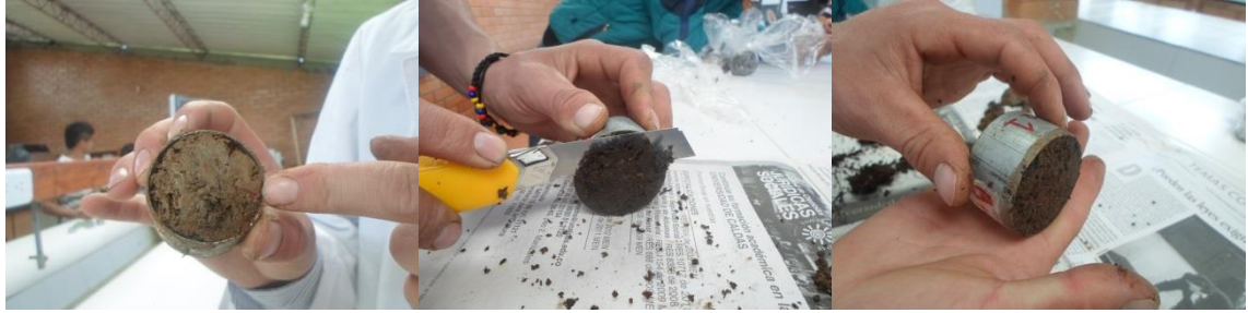
a. Muestra con excesos b. Corte de Excesos de suelo c. Anillos sin exceso
