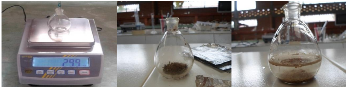
d. Peso del picnómetro vacío e. Adición de 2 g al picnómetro f. Adición de agua hasta la 3 parte del picnómetro
