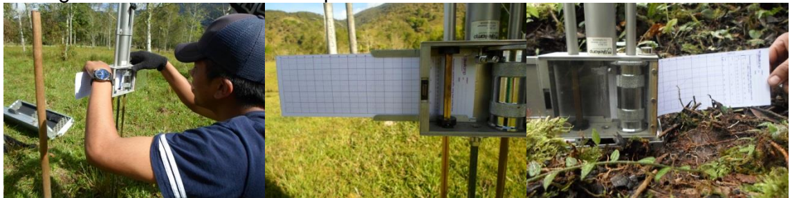
a. Ubicación de la banda para graficar b. banda ubicada desde el punto 0 c. Retiro de la banda
