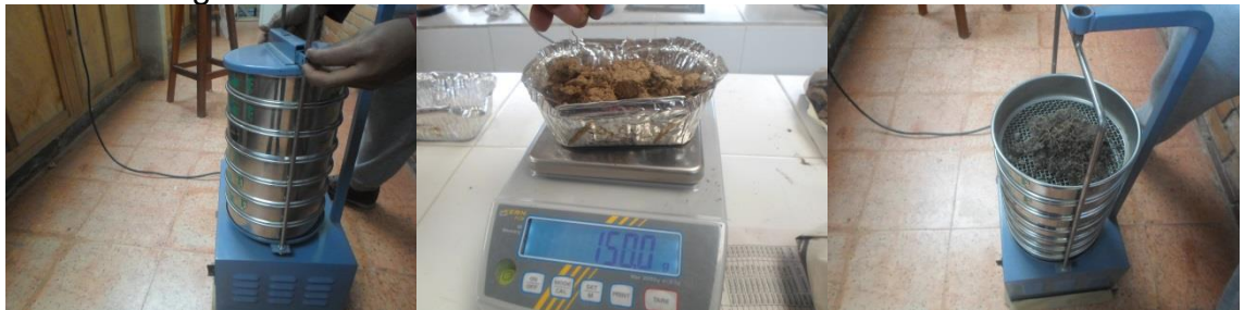
a. Shaker b. Peso de 150 g de suelo c. Agregación del suelo al Tamiz
