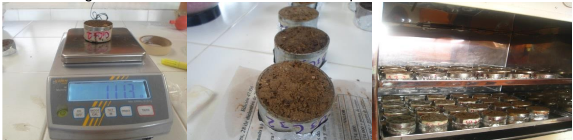
a. Muestra en húmedo b. Recubrimiento de orificio del anillo c. Muestra al horno a 105^{\circ}\text{C}
