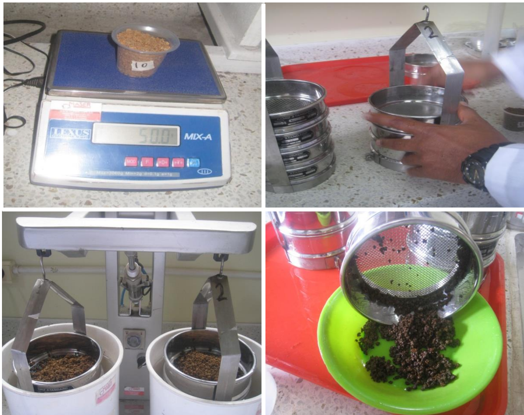
Figura 19. Procedimiento de laboratorio para estabilidad de agregados.
