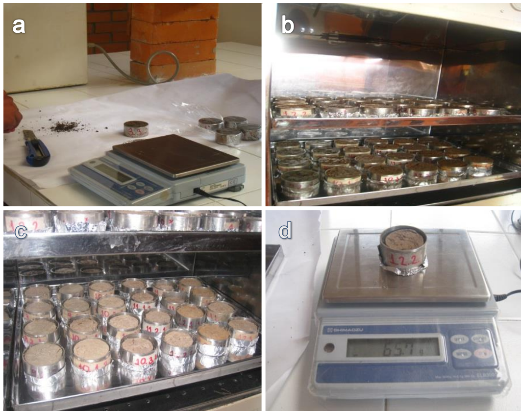
a). Peso de la muestra en húmedo. b). Muestras al horno a ( 105^{\circ}\text{C} ). c). Muestras después de 24 horas. d). Peso de la muestra en seco.
