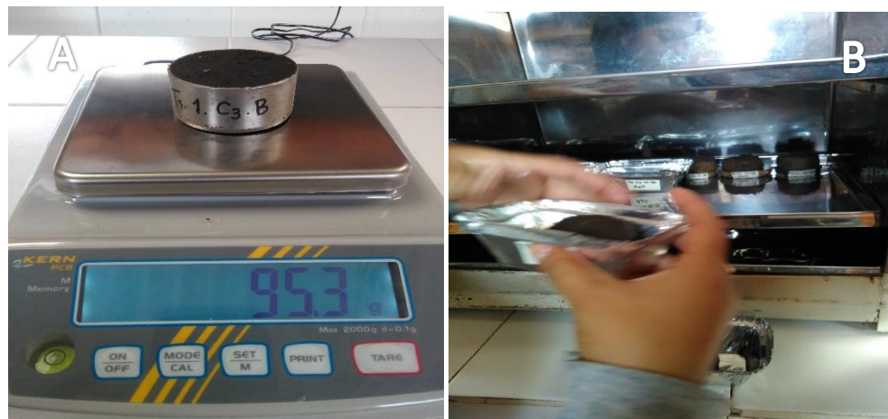
Figura 4. Procedimiento de laboratorio densidad aparente con anillo
