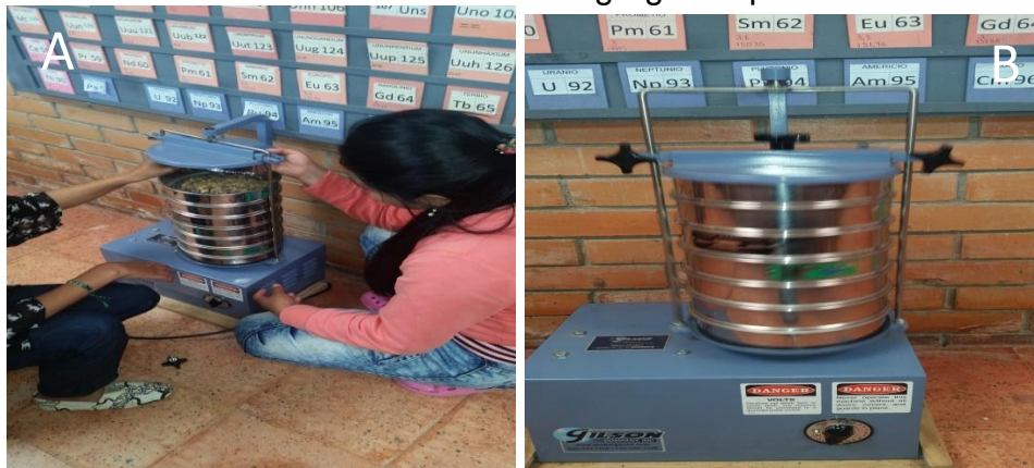
Figura 8. Determinación de la estabilidad de agregados por medio de Shaker.
