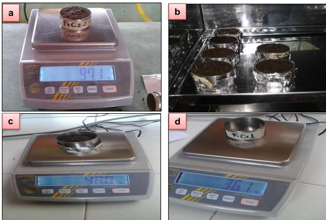
Figura 22. Procedimiento para determinar densidad aparente.
