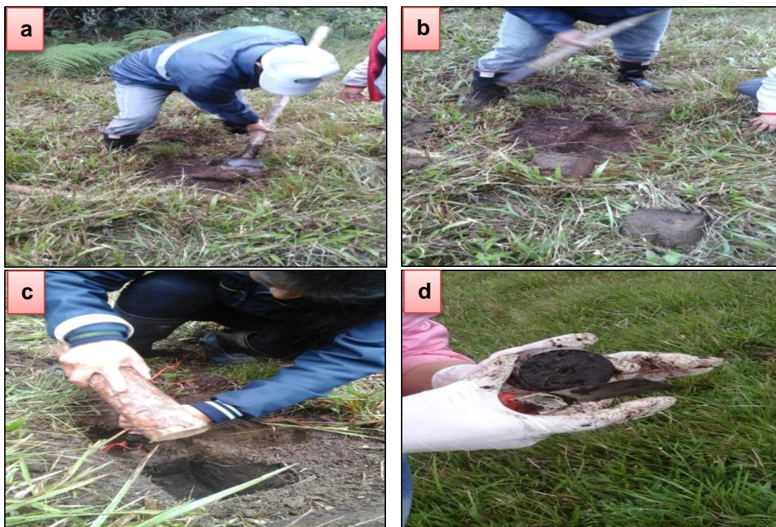
Figura 8. Toma de muestras sin disturbar con anillos de acero.
