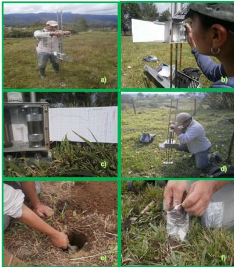
Figura 7. Medición de la resistencia a la penetración RP y obtención de muestras para análisis de humedad gravimétrica
