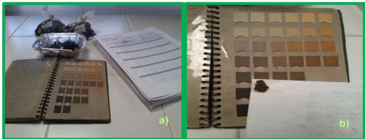
a) Análisis de color en muestra de suelo húmedo. b) Análisis de color en muestra de suelo seco.
