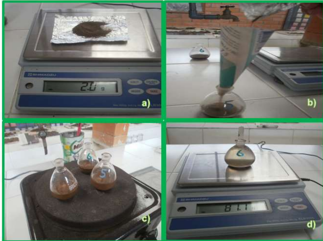
Figura 11. Determinación de la densidad real con picnómetro en laboratorio
