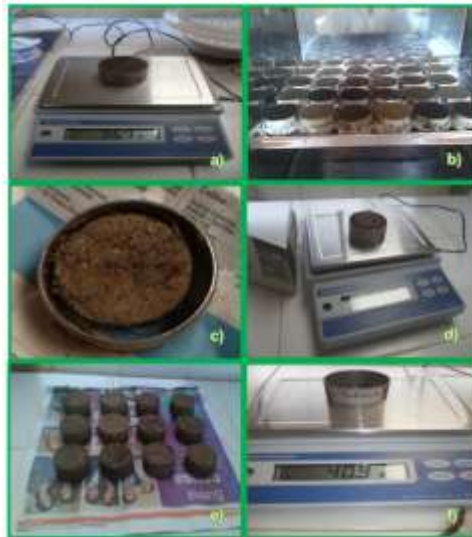
a) Peso del anillo con suelo húmedo. b) Muestras al horno a (105°C). c) Muestras después de 24 horas. d) Peso de la muestra en con suelo seco. e) Muestras resultantes sacadas del anillo. f) Peso del anillo sin suelo.
