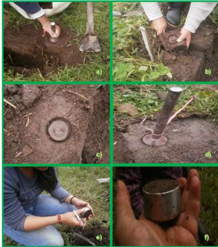
Figura 6. Extracción de las muestras con el cilindro de volumen conocido (anillo)
