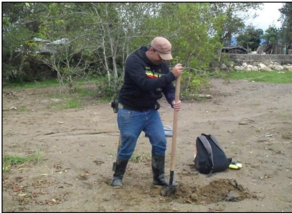
Figura 8. Realizacion de Calicata.
