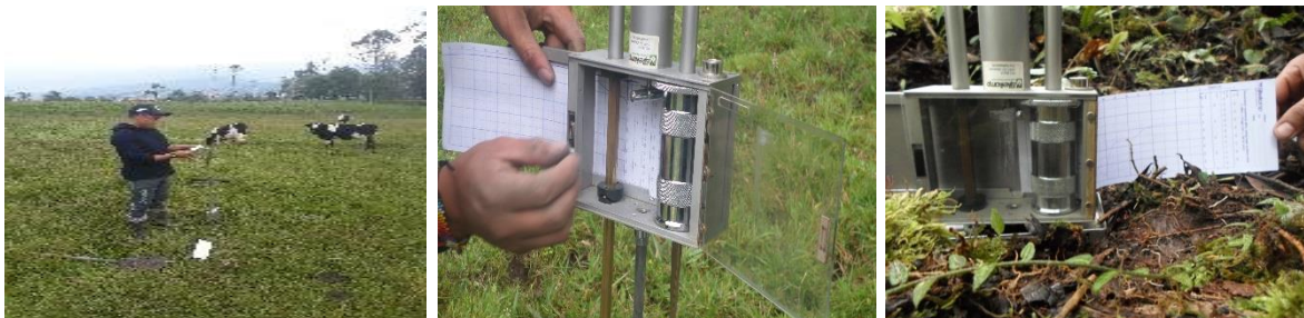
a. Medición de resistencia a la penetración.
