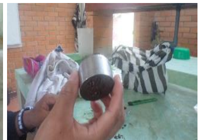
c. Anillos en estado de saturación.
