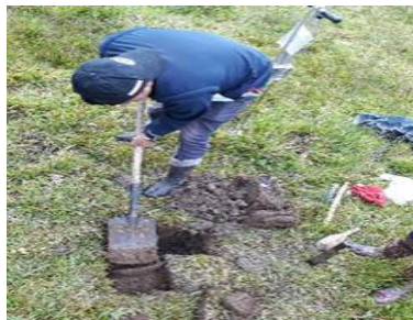
b. Realización de calicata en el predio.
