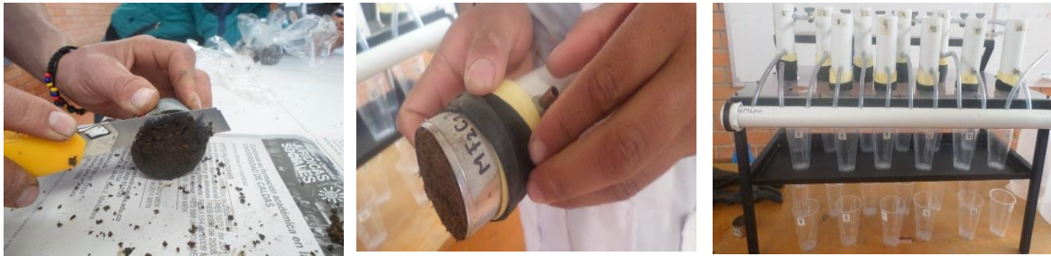
Figura 13. Montaje en el permeámetro.
