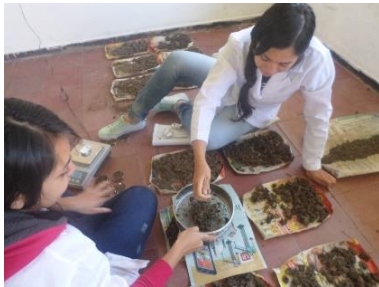
a. Secado a ambiente y tamizado de muestras
